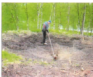
Milen laves som en tragtformet hulning på en skråning.
