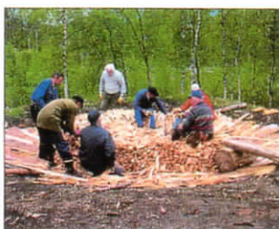
Fyrretræet lægges jævnt og nøjagtigt i tre lag, for at få en jævn brænding.
