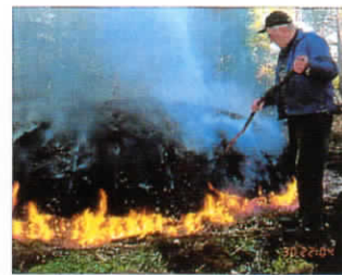
Milen er tændt. I glødelaget yderst er temperaturen ca. 700° mens midten kun er ca. 100°
