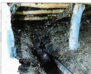
Tjæren tappes på bagsiden af milen i en rende som er lagt fra tæpestokken.
